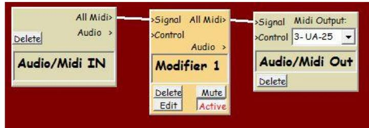
Diese Echtzeit-Verbindung funktioniert nur mit Midi-Signalen. Mit ihr lassen sich gut viele Funktionen des Modifiers testen. Am besten gleich abspeichern unter ModifierThru.room.
